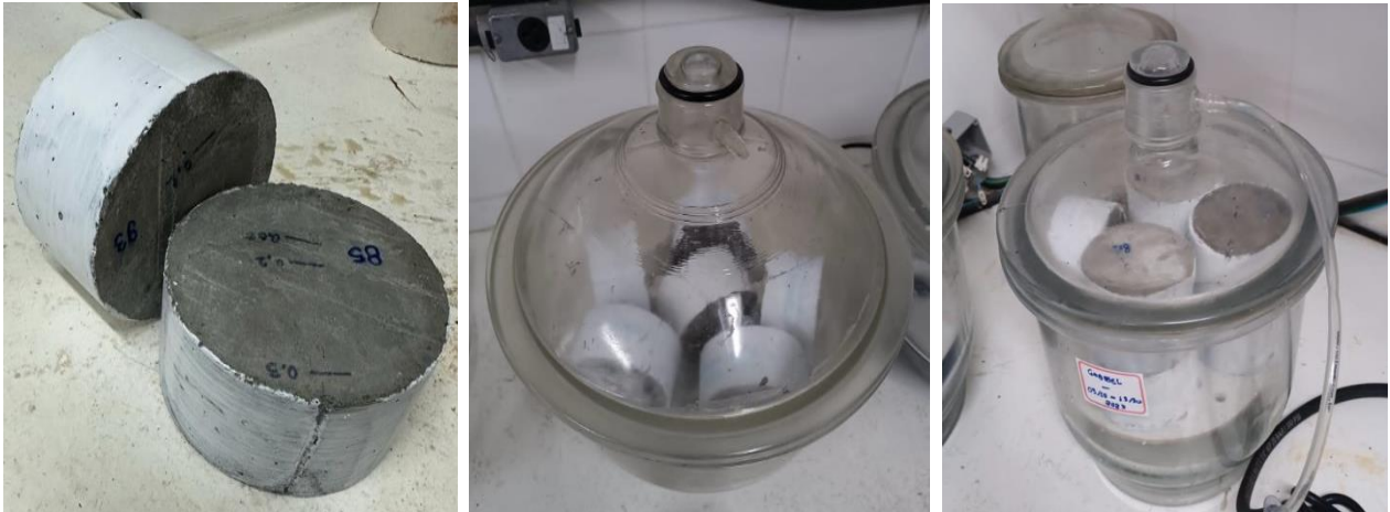
Figura 2 - Corpos de prova impermeabilizados, no vácuo e na sequência inserção da água deionizada.
