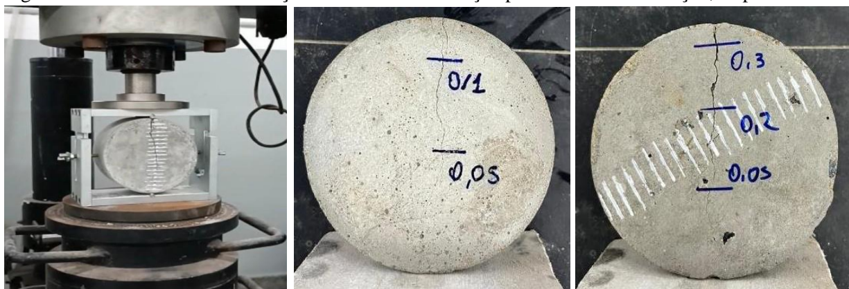
Figura 1- Procedimento de fissuração induzida e mensuração para devida classificação, respectivamente.
