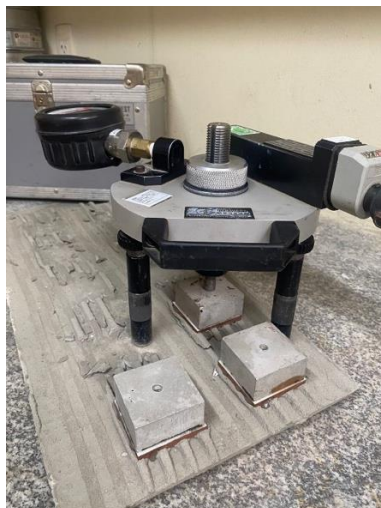
Figura 1 – Ensaio de resistência de aderência à tração
