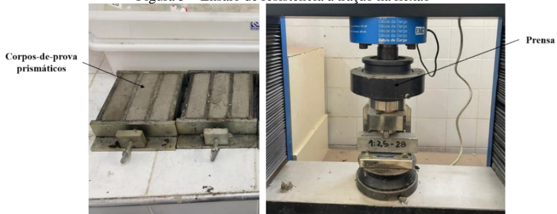
Figura 5 – Ensaio de resistência à tração na flexão
