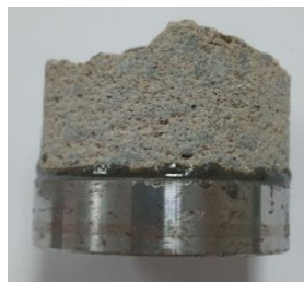
Figura 24 - Argamassa CI.CS.SPA: Ruptura 100% concreto/argamassa.
