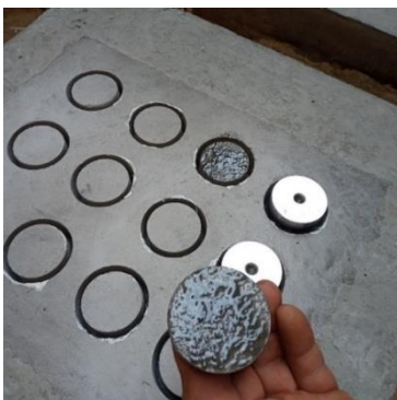
Figura 17 – Colagem das placas metálicas redondas para o ensaio de aderência a tração.
