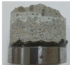
Figura 25 - Argamassa CI.SA.CS.CPA: Ruptura 100% concreto.
