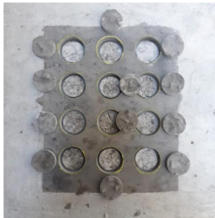
Figura 22 – Corpos de prova da argamassa EP.CS.SPA desprendidos do substrato durante o corte.
