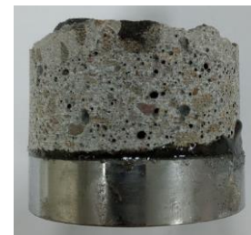
Figura 26 - Argamassa CI.SA.CP.SPA: Ruptura 100% concreto.
