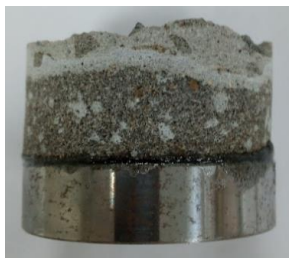
Figura 23 - Argamassa EP.CS.CPA: Ruptura 100% concreto.
